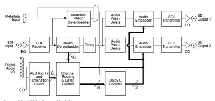
Fig 1-4: RB-VHEDD8 System Block Diagram.
