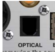
Fig 3-12: PS-PLAY TOSLINK Output
